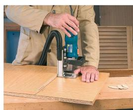
Ensamblaje en medio del tablero
