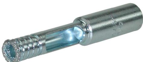
Para un mejor resultado la broca requiere lubricación, se recomienda mojar con un poco de agua la superficie a taladrar antes de comenzar, y con un taladro de alta velocidad (2000-2500 rpm) solo con una ligera presión.
